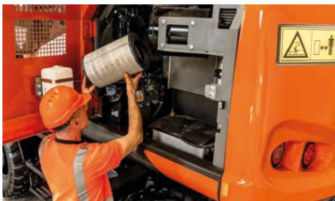
Údržba se snadno provádí přímo ze země.
