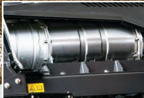
System SCR snižuje hladiny emisí a hluku.
