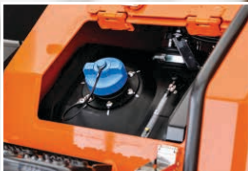
Vstřikování močoviny do výfukových plynů snižuje emise.
