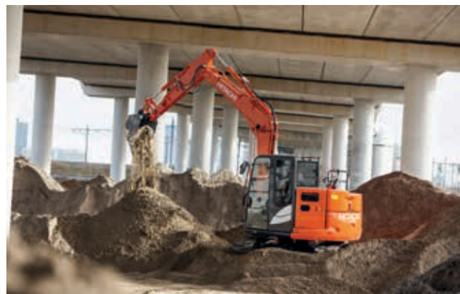
Poloměr otáčení krátké zádě stroje ZX85USB-6 je ideální pro práci ve stísněných prostorech.
