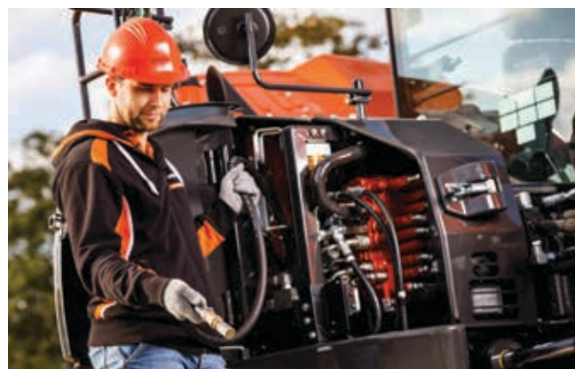
Palivo je do rypadla možné doplnit pomocí elektrického čerpadla.
