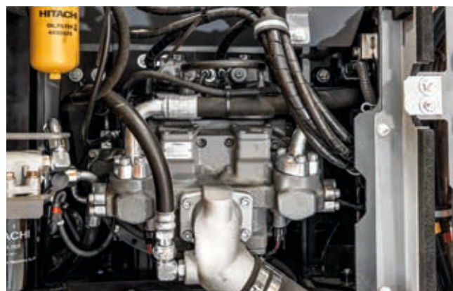
Úspora spotřeby paliva až 7 % je dosažena díky hydraulickému systému HIOS IV.
