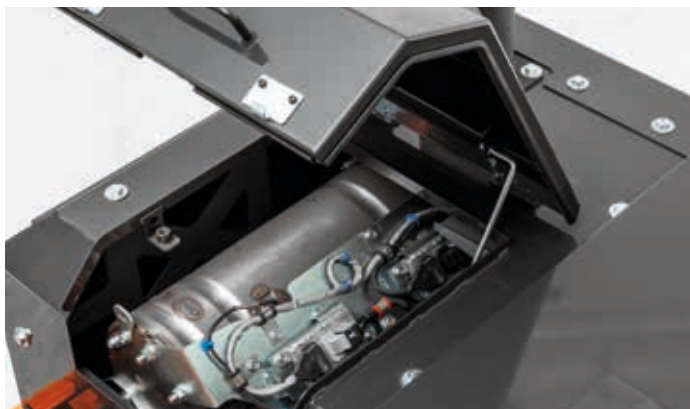
Servisní intervaly pro filtr CSF se prodloužily z 4 000 na 6 500 hodin.
