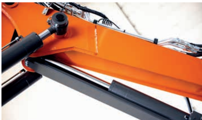
Ochrana válce výložníku zvyšuje robustnost.
