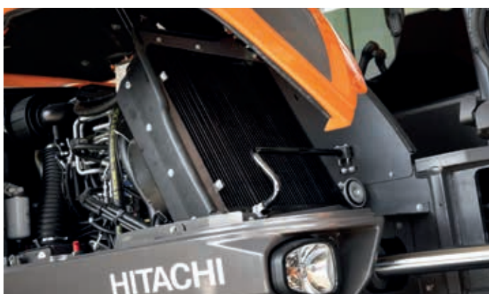
Prostor chladiče se snadno čistí.
