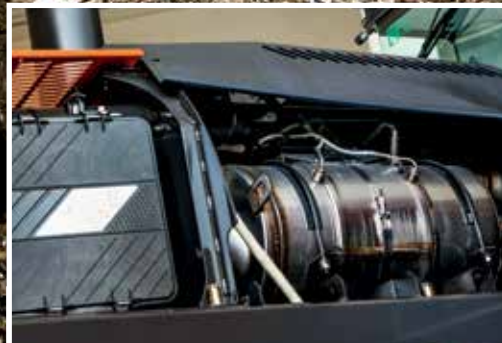
System SCR snižuje hladiny emisí a hluku.
