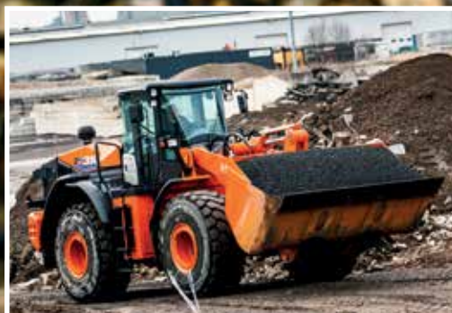
Funkce regulace podvozku zlepšuje stabilitu stroje při jízdě.
