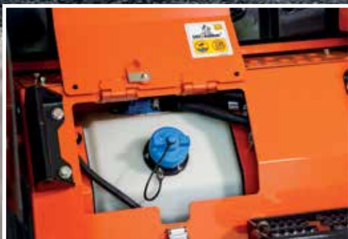
Vstřikování močoviny do výfukových plynů snižuje emise.
