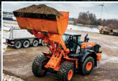
Systém s tlumicím ventilem zaručuje hladký pohyb zvedacího ramene.
