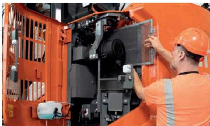
Zvětšené dveře chladiče (ZX135US-7) umožňují snadný přístup k čištění a údržbě.
